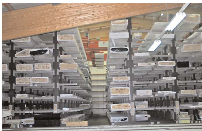
In dem Hochlager werden 13 m-Stangen nach chaotischem Prinzip platzoptimiert abgelegt
