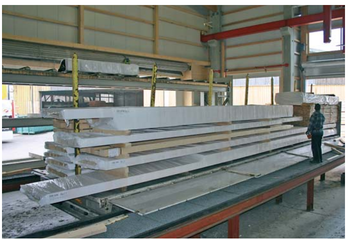
Lkw-Verladung à la Schneider: Mitarbeiter braucht die Pakete vom Rollengang nur noch aufladen
